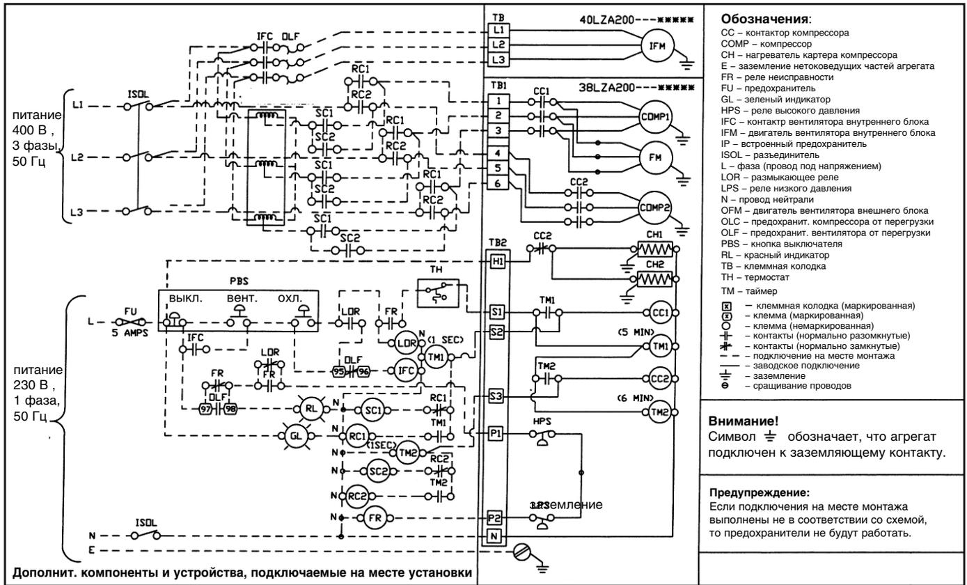
Схема с пусковым автотрансформатором
