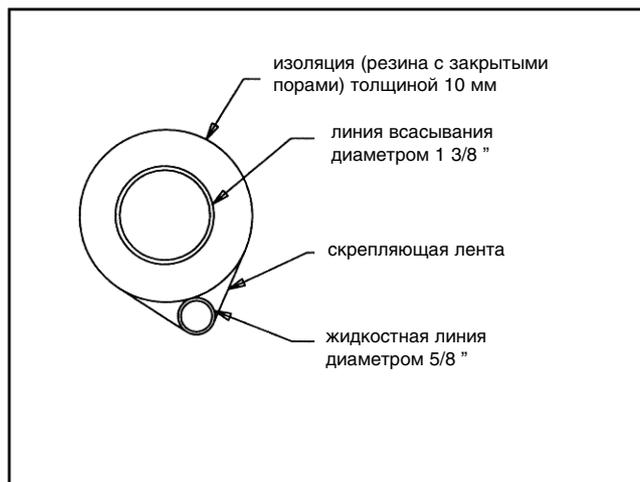
Рис. 7 Теплоизоляция труб
