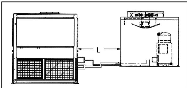
Рис. 6-3 Максимальная длина горизонтального трубопровода
